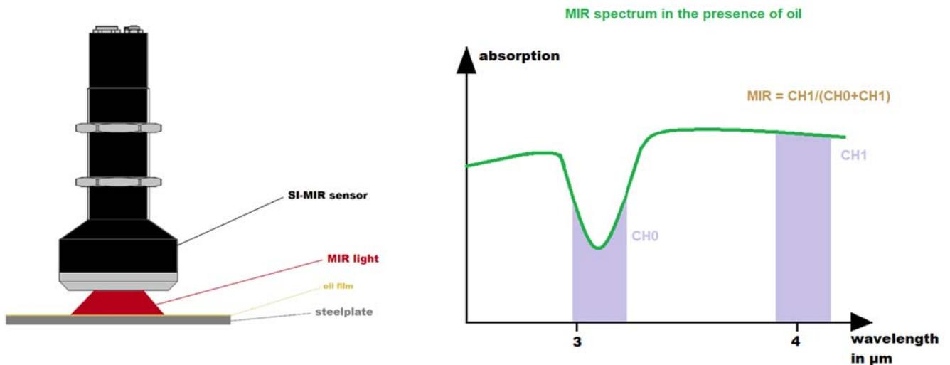
La fenêtre de mesure gauche  $CH0$  détecte l'absorption provoquée par la couche d'huile, tandis que la fenêtre de mesure droite n'en est dans une large mesure pas affectée :
